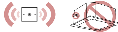
Alarma visual y auditiva y aislamiento de las unidades interiores afectadas cuando se detecta una fuga
